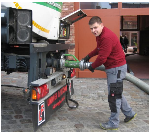
Komfortable Befüllung eines Pelletlagers in einem Mietshaus in Berlin-Schöneberg
