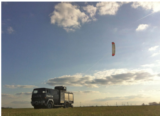
Testflug der EnerKite-Flugwindkraftanlage. Quelle: EnerKite GmbH
