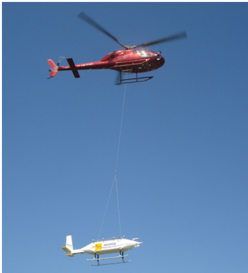
Im Rahmen von Flugexperimenten mit Hubschraubern (Helipod) und Kleinflugzeug (MAV) konnten erste neuartige experimentelle Daten zur Turbulenz und zu Wake-Effekten gewonnen werden. Quelle: Forwind / Michael Schmidt
