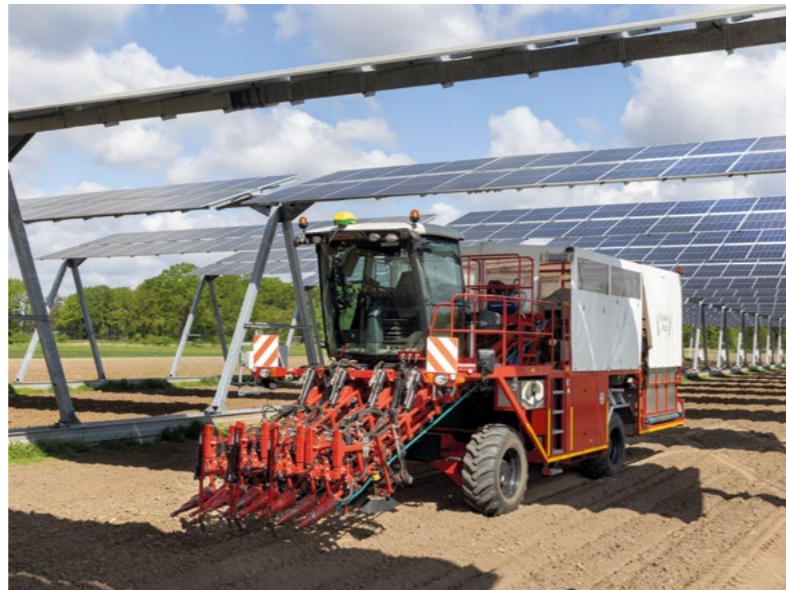
Bewirtschaftung unter der Agri-PV Anlage
