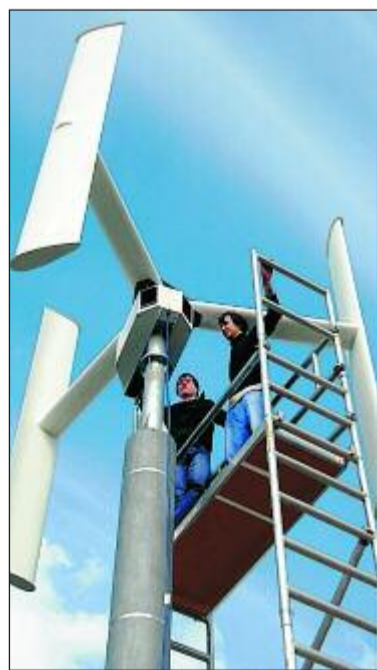
In dem Chemnitzer Unternehmen Fiber-Tech products GmbH testen die Studenten Jens Vettermann (links) und René Melzer von der Fakultät Maschinenbau der TU Chemnitz eine vertikal arbeitende Windkraftanlage, die sie während ihres Praktikums gemeinsam mit Mitarbeitern des Betriebes entwickelt haben. Die Rotorblätter wurden aus Faserverbundstoffen gefertigt. –FOTO: ZB/ARCHIV
