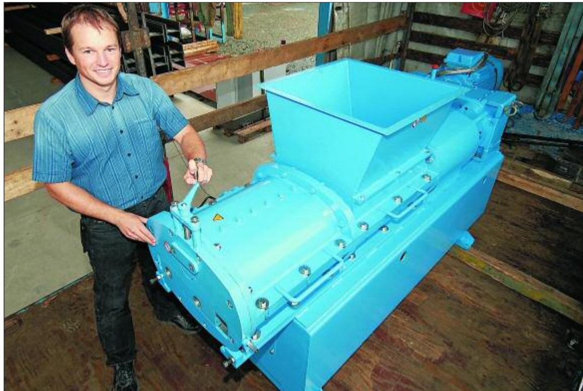
Matthias Körner von der Maschinenbaufirma Lehmann hat den Extruder konstruiert, der als Vorstufe zu einer Biogasanlage benötigt wird. –FOTO: ULF DAHL
