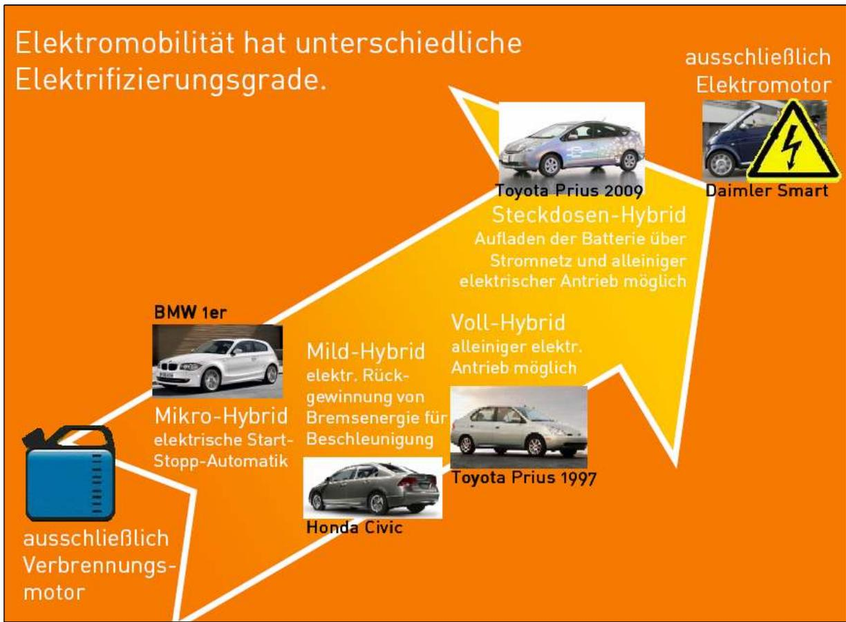
Größere Batterien in Hybridfahrzeugen (so genannte Plug-In-Hybrids) werden über die Steckdose aufgeladen. Der Verbrennungsmotor dient dann nur noch als „Notstromaggregat“ zur Verlängerung der Reichweiten über die Speicher-kapazität der Batterie hinaus.
