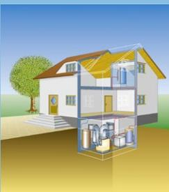
Luft-Wärmepumpen können sowohl im Freien als auch innerhalb des Gebäudes aufgestellt werden. Bei so genannten Split-Wärmepumpen ist die Wärmepumpe in ein Innen- und Außengerät aufgeteilt. Das Außengerät ist dann besonders kompakt. Der Marktanteil der Luft-Wärmepumpen ist in den letzten Jahren stark gestiegen und übertrifft seit 2010 den Marktanteil der erdgekoppelten Systeme.
