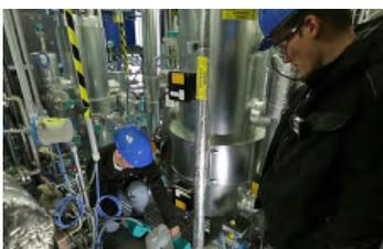
Elektrolyse, in der das zu Dampf erhitzte Wasser in seine Bestandteile gespalten wird: Sauerstoff und Wasserstoff. Letzterer reagiert anschließend mit CO<sub>2</sub> zu einem Synthesegas, das in Kohlenwasserstoffe umgewandelt wird. Aus dem dabei entstehenden Rohprodukt kann mittels einer Standard-Raffination Kerosin, Diesel, Benzin und andere petrochemische Produkte gewonnen werden.
