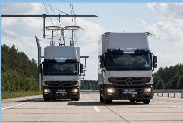
„Trolley-Lkw“ auf einer Teststrecke mit elektrischer Oberleitung
