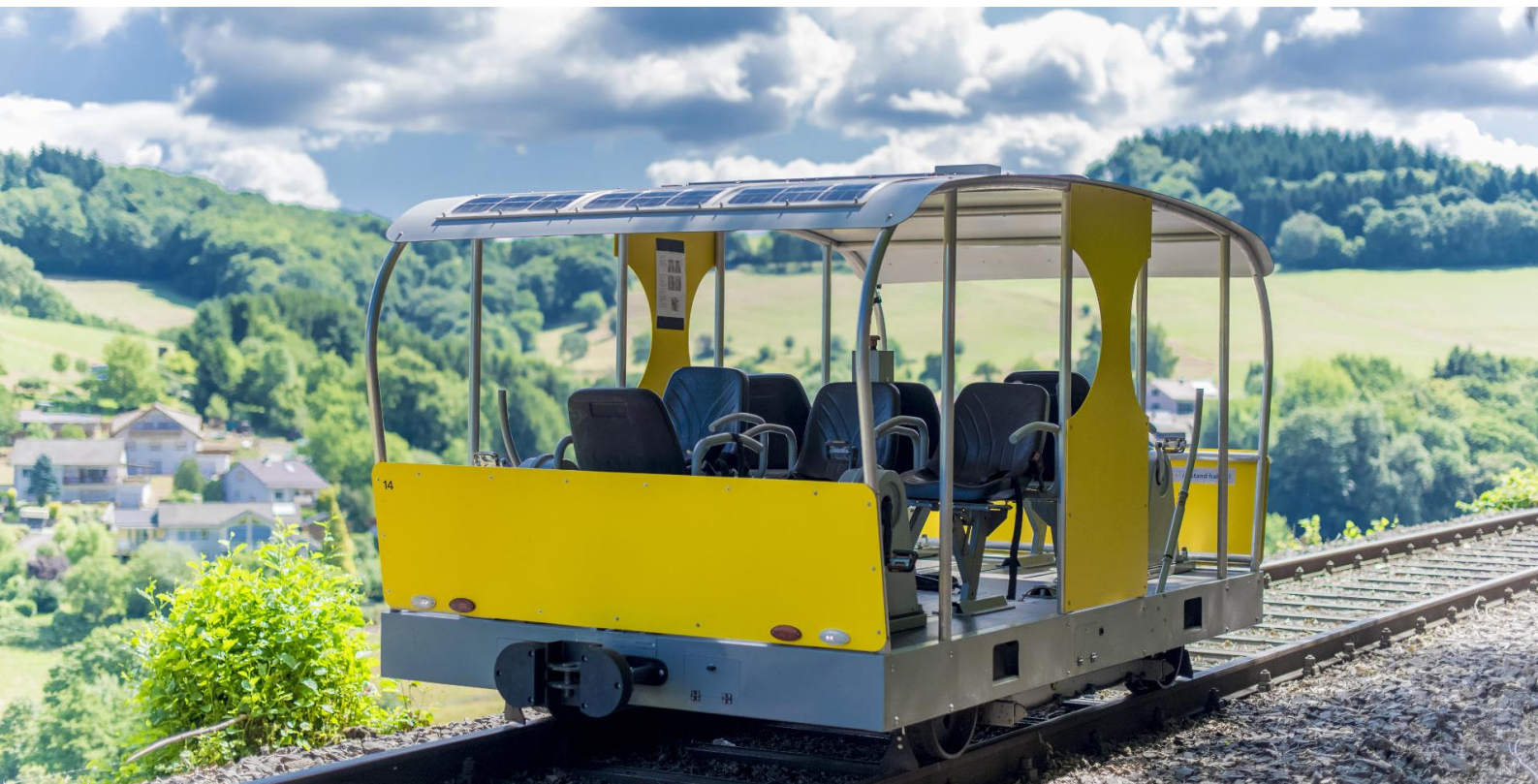
Die solarbetriebene Draisine im Odenwald. Quelle: Überwaldbahn gGmbH
