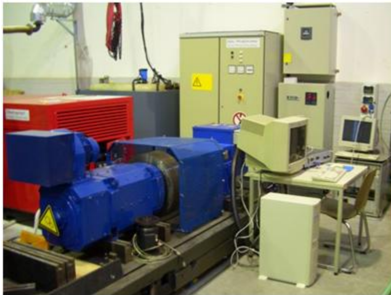
Abbildung 129: Der 80 kVA-Maschinensatz als Nachbildung einer Windenergieanlage
