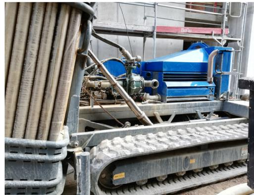
Bohrgerät für Sonden
