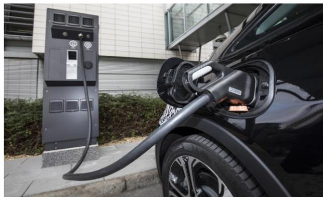
Opel Ampera-e an einer 50 kW Gleichstrom-Schnellladestation. 30 Minuten reichen aus, um den E-Pkw fit für weitere 150 km zu machen.
