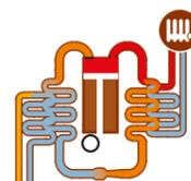
Der elektrische Kompressor der Erdwärmepumpe verdichtet den Dampf. Dadurch steigt dessen Temperatur. Die Wärme kann dann zum Heizen und für die Warmwasserbereitung genutzt werden.
