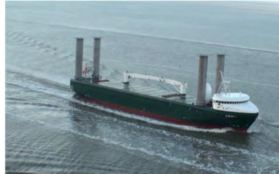
Das E-Ship 1 der Enercon GmbH transportiert Windenergieanlagen mit Unterstützung des Windes auf hoher See.
