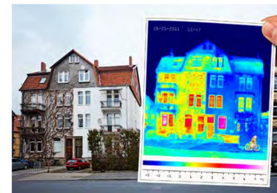
Thermische Schwachstellen sind im Wärmebild leicht erkennbar: Über die Fassade verliert die ungedämmte linke Haushälfte viel Energie. Auch die Schwachstelle „Fenster“ wird mit Hilfe des Wärmebildes deutlich.
